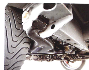
リアのアームはバナゴン用を流用し、これにポルシェのブレーキなどを合体させたハイブリッド。リアサスもビルシュタイン製。
