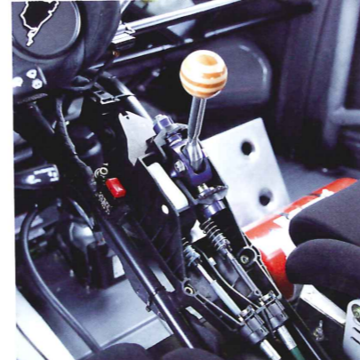
シフターはサブフレームをセンターコンソール部に組み、その上にポルシェ917用のワイヤーシフターをかなり高い位置に装備する。
