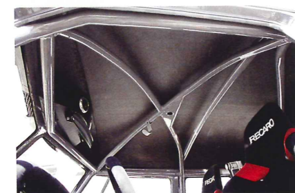
独自の形状で組まれたロールバーによって、強度のアップだけでなく、万が一の横転の際も乗員を保護する仕組みになっている。
