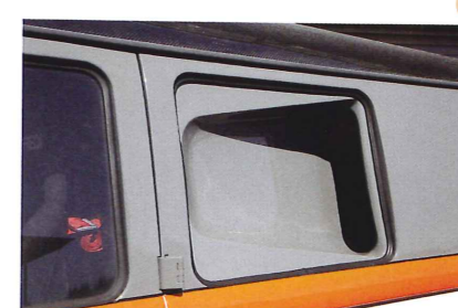
サイドウィンドー最後部分は、インタークーラーへと冷却風を導入するための開口部となっており、ダクトを通じてインタークーラーへと続いている。
