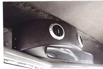
純正のエアベンチレーターもご覧のようにしっかりと改良され、備わっている。速度が速度なので、かなりの風量となるんだとか。
