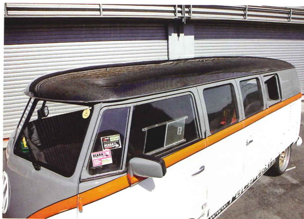
ルーフはパネルを一度カットし、カーボンファイバー製で作直したものを貼り付けている。非常に軽量で、見た目よりも大幅に重心を下げている。
