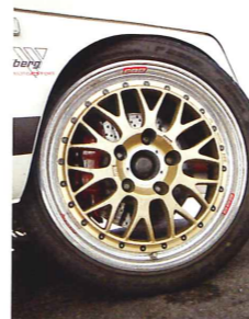
ホイールはBBS Racingの3ピースでフロント8.5インチ、リア10インチ幅。それぞれ235/40-18、285/35-18のピレリP-ZEROを履く。
