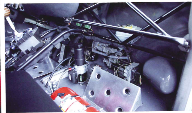
助手席の足元にはABSのユニットやその他電気系統が集約されている。もちろんそのデバイスは全てポルシェからの流用だ。
