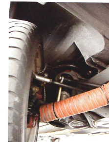
ダブルウィッシュボーン+コイルオーバー化されたフロントは、専用チューンのビルシュタイン製ダンパーを装着する。
