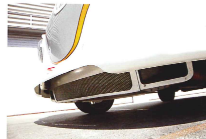
ラジエターグリルなどの開口部を持たないため、フロントバンパー下に隠された導風ダクトによって、その奥のオイルクーラーにフレッシュエアを送っている。
