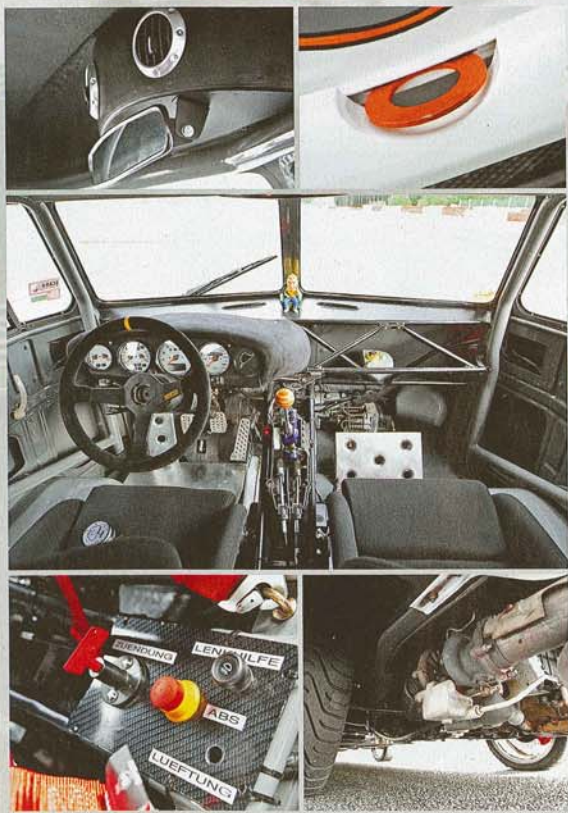
Oben links: Trotz Kühlluft-Auströmer klettert die Innen-Temperatur im Rennbetrieb auf Saunaneiveau Oben rechts: Wie jedes Rennfahrzeug verfügt auch das Race-Taxi über einen gut zugänglichen Abschlepphaken Mitte: Diese Art von Cockpit stand Ben Pon 1948 garantiert nicht im Sinn, als er die Grundzüge des VW Transporters skizzierte Unten links: Präzise und logisch – Rennauto-Armaturen müssen nicht schön, sondern intuitiv bedienbar sein Unten rechts: Quell der Freude: Die zwei Serienturbolader verhelfen dem 3.6 zu einer beeindruckenden Literleistung von 113 PS/l
